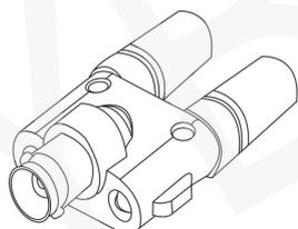
图三 BNC 母头转双接线柱
