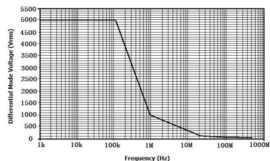
图 4 DP6700A 最大差模电压 VS 频率
