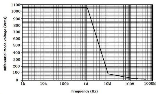
图 2 DP6150A 最大差模电压 VS 频率
