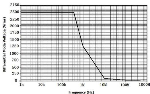
图 3 DP6350A 最大差模电压 VS 频率
