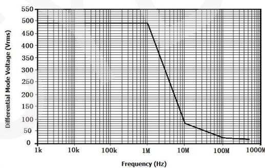
图 1 DP6070A 最大差模电压 VS 频率
