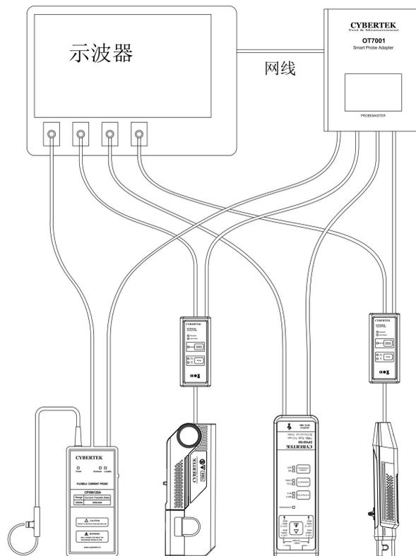
上述示意图表示了智能探头控制器、我司带通讯功能的智能探头和示波器三者之间连接及使用方法：
