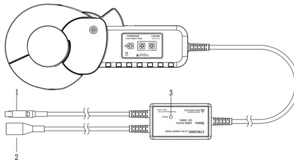
1. **供电线:**  $\pm 12V$  供电，雷莫接口，可兼容部分功率分析仪的供电接口
