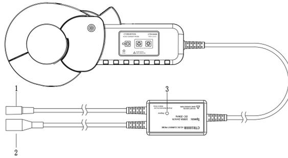
1. **供电线:** 供电线连接 12V 适配器。
