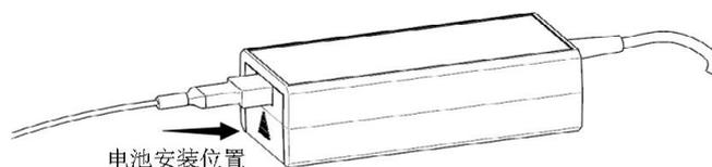
产品标配 7.4V/950mAh 两块锂电池，如上图所示：电池安装位置，本设计在插入衰减器后，衰减器起到限位作用，电池无法取出，如需取出电池充电，参考如下步骤：
