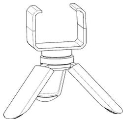
光电发射器支撑架 (CK-690)
