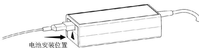
产品标配 7.4V/950mAh 两块锂电池，如上图所示：电池安装位置，本设计在插入衰减器后，衰减器起到限位作用，电池无法取出，如需取出电池充电，参考如下步骤：
